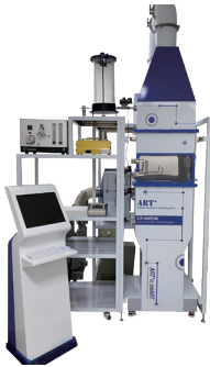
자동차 승객실용 에어필터 입자효율 성능평가 시스템 (CF-2010W)
