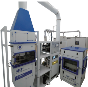
자동차 승객실용 에어필터 가스효율 성능평가 시스템 (CF-1916W)
